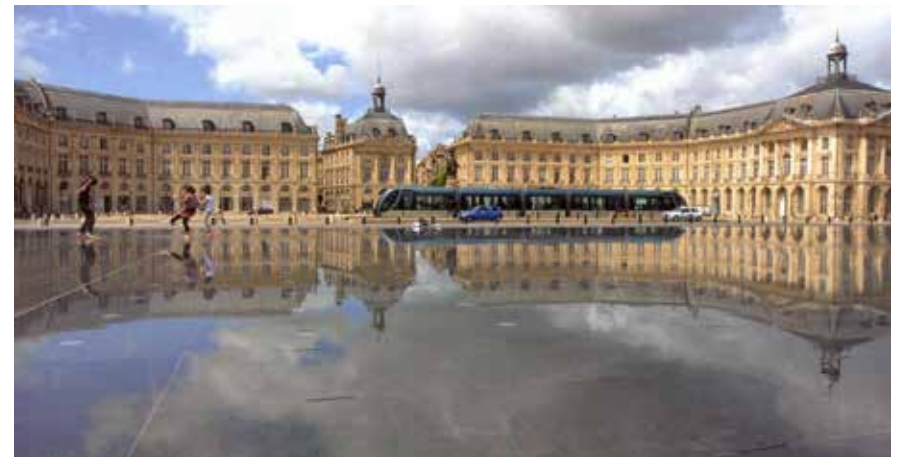
Afwezigheid van bovenleiding en bijbehorende palen geeft een heel rustig straatbeeld.
