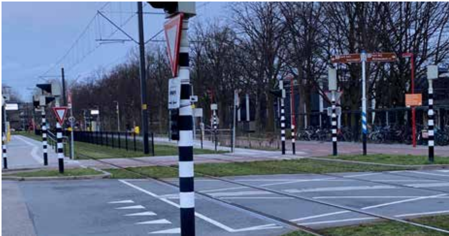
Bij een hoge snelheid zijn allerlei objecten nodig om een oversteek veilig te maken wanneer de tram langs rijdt. Deze objecten dragen niet bij aan de ruimtelijke kwaliteit.
