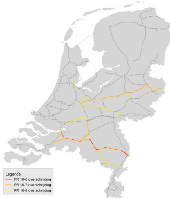
Figuur 3.7: toetsing van het gerealiseerde transport in 2019 aan de risicoruimte Basisnet Spoor (bron: monitoringsrapportage basisnet spoor 2019).
