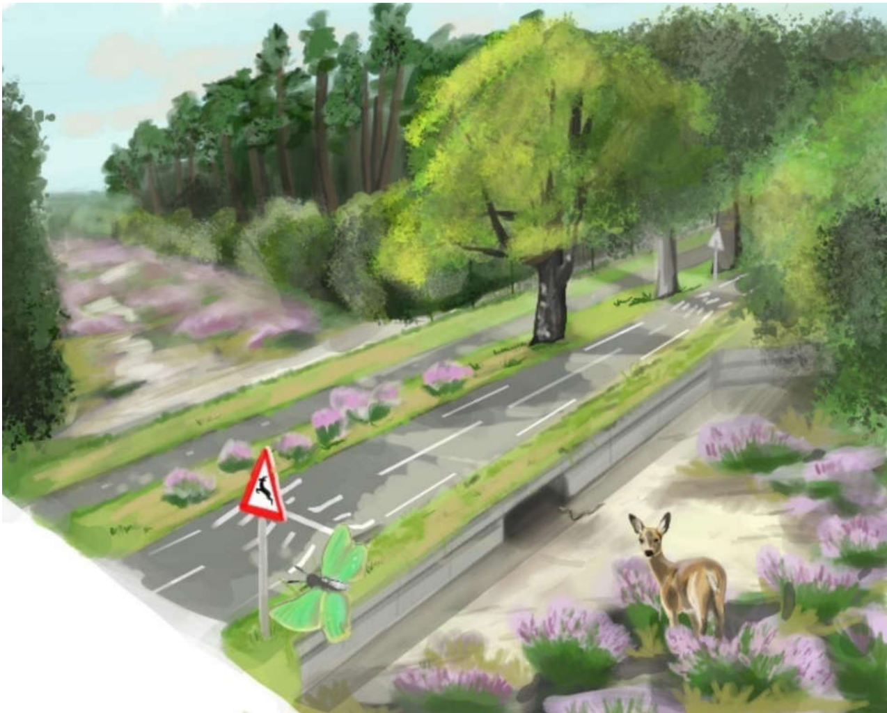
Figuur 16.18 | Artist impression van een grote faunatunnel ter hoogte van de gasstrook op Landgoed Den Treek Henschoten. Betonnen geleiding zorgt ervoor dat kleine grondgebonden dieren niet op de weg kunnen komen en in de tunnel worden geleid. De exacte locatie van de tunnel is afhankelijk van de ligging van de gasleidingen. Verkeersvertraging op dit punt is een optie die hierbij een goede aanvulling zal kunnen zijn om naast reewild ook overstekende recreanten te beschermen. Langs de gasstrook loopt een wandelroute die op deze locatie de weg doorkruist.
