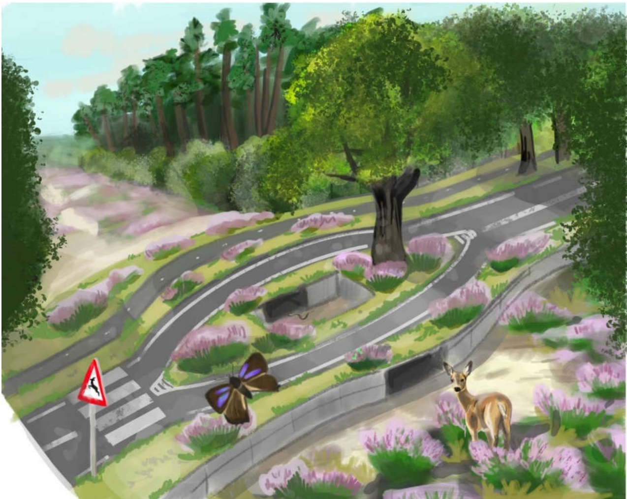
Figuur 16.19 | Artist impression van een grote faunatunnel ter hoogte van de gasstrook op Landgoed Den Treek Henschoten inclusief middenberm. Hierdoor kan het heidebiotoop doorlopen en is er een kortere afstand te overbruggen voor minder mobiele vliegende soorten. De betonnen geleiding zorgt ervoor dat kleine grondgebonden dieren niet op de weg kunnen komen en in de tunnel worden geleid. De exacte locatie van de tunnel is afhankelijk van de ligging van de gasleidingen. Verkeer wordt in dit scenario vertraagd. Langs de gasstrook loopt een wandelroute die op deze locatie de weg doorkruist, ook overstekende recreanten worden hiermee geholpen.
