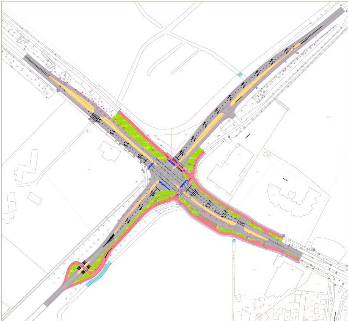
Figuur 8; variant 1 - VRI kruispunt met gelijkvloerse overstek voor langzaam verkeer
