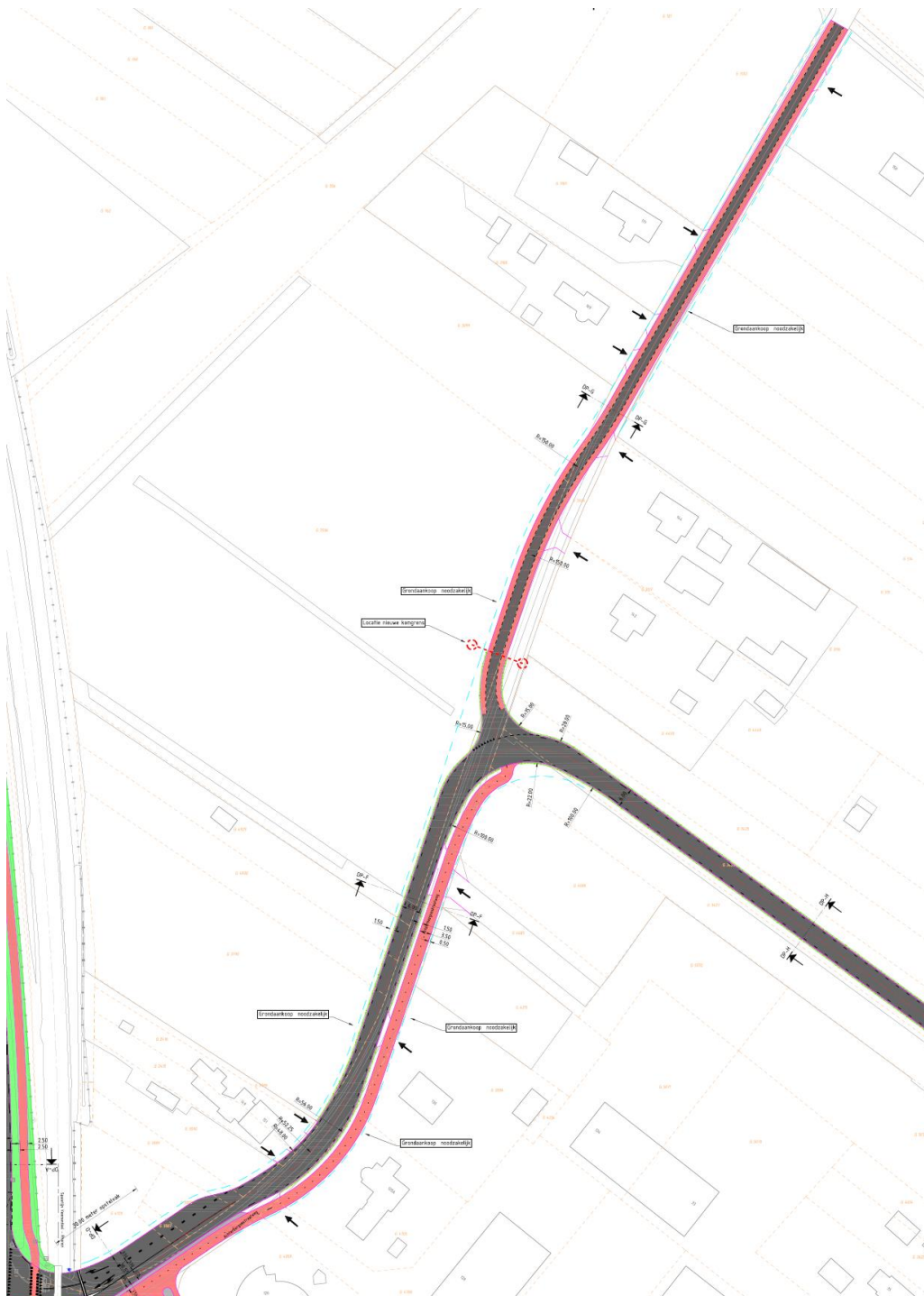
Figuur 23: Optimalisatie vrijliggend tweezijdig fietspad overgaand in fietssuggestiestroken op de Achterbergsestraatweg (oost)
