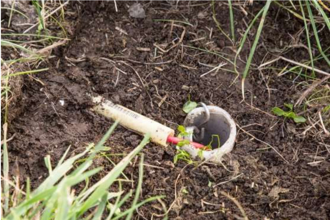
Bekabelde meetapparatuur van de onderwaterdrainage, even blootgelegd voor de foto.
