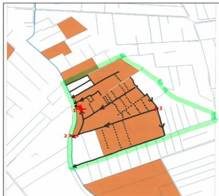
Figuur 2.6 Oppervlaktewaterbeheer in de Bennekomse Meent. Legenda: oranje = bezittingen van Staatsbosbeheer; doorgetrokken lijnen en pijlen = ligging en stroomrichting van de sloten; stippellijnen = ligging ondiepe greppels; 1 = molen en stuw; 2 = duiker; 3 = dam; groene lijn = grens Natura 2000-gebied (bij benadering).
